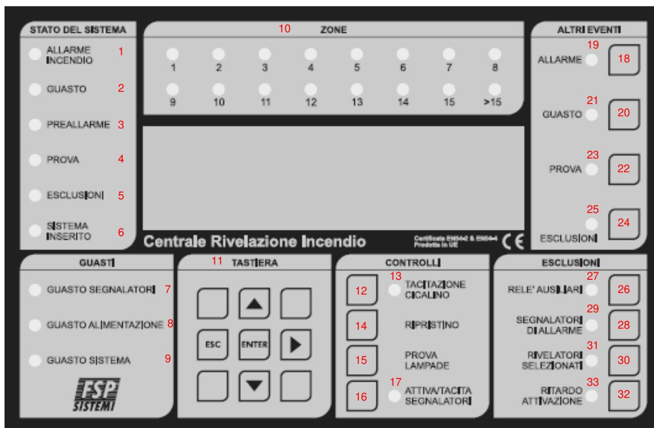
1. **STATO DEL SISTEMA - ALLARME INCENDIO:** Il LED rosso acceso indica una condizione di allarme (sul display sarà possibile leggere se allarme incendio o altro)
